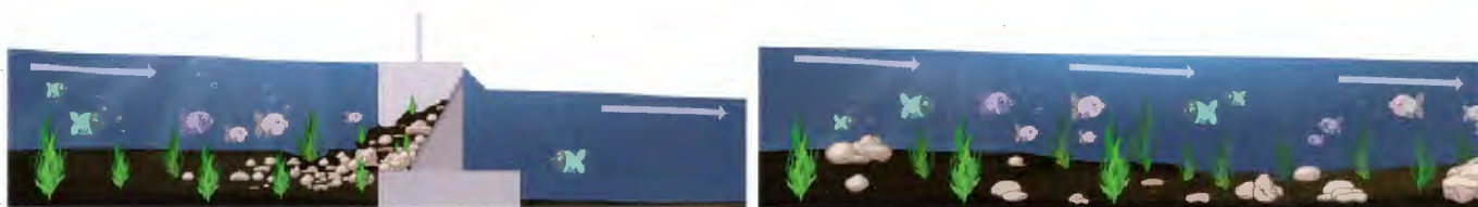
La suppression d'un clapet permet le rétablissement de la continuité écologique
